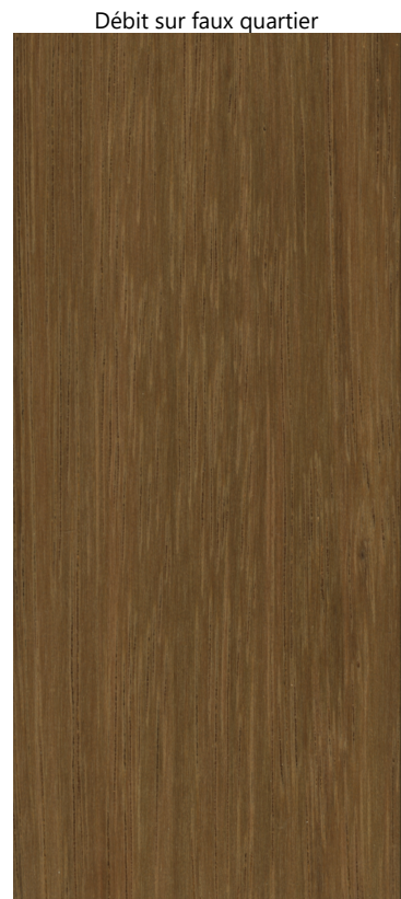
Débit sur faux quartier
